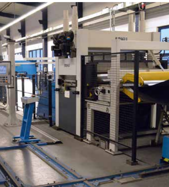
Einlaufseite der Bandstanzanlage mit Coilladestation, Haspel, Richtmaschine und Schlaufengrube.
