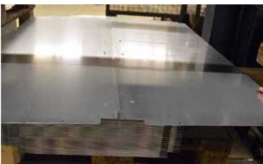
Die beiden Zuschnitte zeigen nebeneinandergelegt den Vorteil des über die Bandbreite gehenden Trennschnitts in der Presse der Pivatic Anlage.
