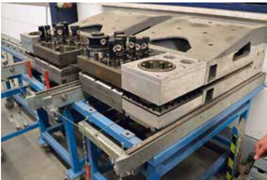
Die beiden Werkzeugträger der Stanzeinheit „Piva-Punch“ werden komplett quer zur Bandlaufrichtung positioniert.
