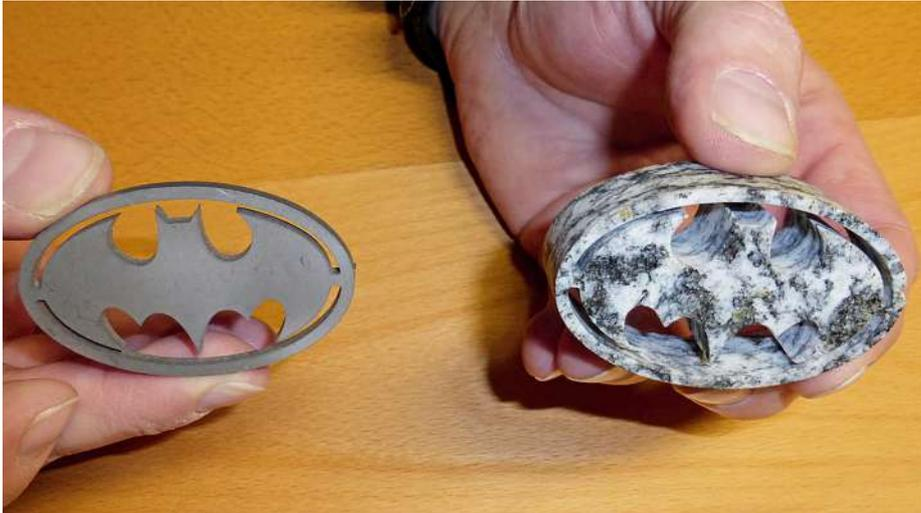
**Die Batmanlogos wurden wasserstrahlgeschnitten, das rechte Modell aus 15 mm dickem Granit. Die feinen, genauen Spitzen der Ohren und der Flügel kann nur ein Wasserstrahl erzielen.**
